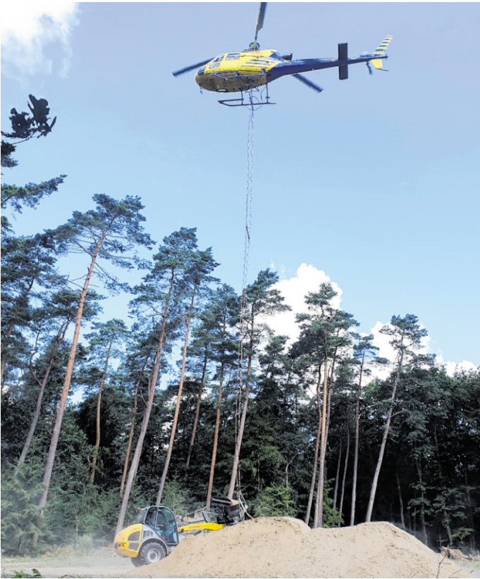
Am Befüllplatz wird der Helikopter mit Kalkmaterial beladen. Von dort aus bringt er Dolomit beziehungsweise Dolomit-Holzasche-Gemische auf die Waldflächen aus, um versauerte Waldböden zu stabilisieren (Archivbild aus dem Stadtwald Eberbach aus dem Jahr 2023).
