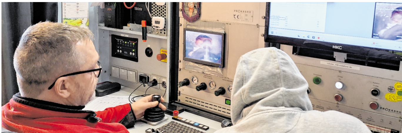
Mit einem Fräse-roboter werden die Abzweigungen und Zuläufe am Ende wieder geöffnet. Die minimalinvasive Vorgehensweise wird unmittelbar vom Bildschirm aus gesteuert.
